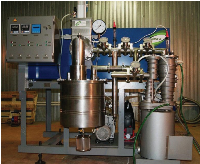
Рис. 14. Сучасний демеркурізатор: вакуумна термодинамічна установка демеркурізації УРЛ-2м. Продуктивність — 200 ламп за годину.
