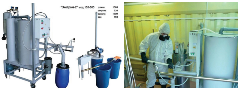
Рис. 12. Установа для знешкодження та утилізації ртутьвмісних ламп «Экотром-2». Саме така установа плідно працює в Одесі.
