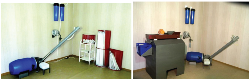
Рис. 13. Установа поділу компонентів, знешкодження та утилізації ртутьвмісних ламп і відходів «Экотром-2У» та мобільна установа мокрого дроблення і утилізації ламп «Экотром-2ДУ».
